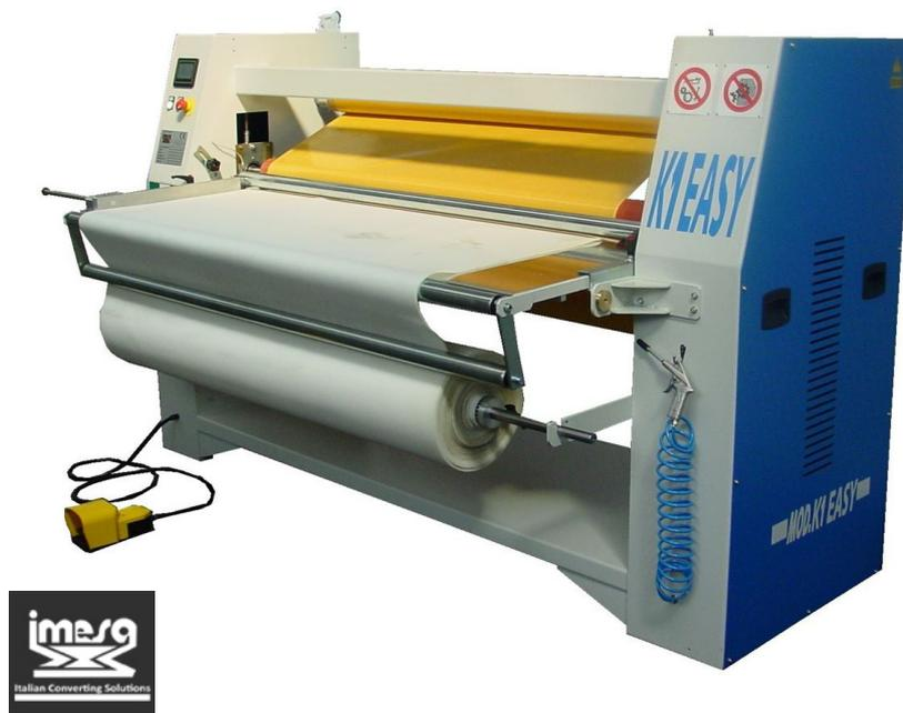
La calandra K1 Easy es un sistema diseñado para el laminado a una cara con opción a doble cara de adhesivo en caliente o frío sobre diversos foams, espumas, textiles, cintas adhesivas y no adhesivas, goma, corcho y similares. Es una calandra diseñada para lograr excelentes resultados con una contenida inversión. Muy sencilla de manejar y compacta. Hasta 1600 mm de anch de material. Velocidad 5 m/min ajustable mediante inverter.
