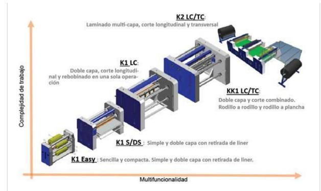
Generalmente enfocadas hacia el trabajo con materiales flexibles, como cintas adhesivas, cintas de doble cara, cintas de polímero flexibles, espumas, gomas, fieltros, materiales de caucho con recubrimiento de grafito y textil resinado, etc. Posibilidad de diferentes configuraciones de equipo, así como sistemas de fijación del adhesivo mediante zonas con calor y/o rodillos calefactados.
