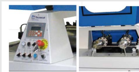
Tecnocut establece un nuevo concepto de bombas Jetpower y Jetpower Evo de alta presión y elevadas prestaciones mediante un sistema bicilíndrico con dos cilindros paralelamente sincronizados que permiten conseguir presión constante de agua, evitando las caídas típicas de rendimiento de los intensificadores tradicionales. El control y monitorizado de la presión se efectúa a través de la consola móvil.
