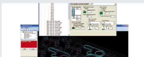
Paquete Tecnocam preinstalado necesario para completar la gestión de los sistemas de corte por chorro de agua. Desarrollado como resultado de una vasta experiencia de Tecnocut en el sector del corte hidroabrasivo. Incorpora una base de datos de materiales y un sistema de nesting y de gestión del corte con simulador de costes y materiales incluido.
