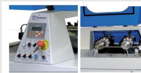
Tecnocut establece un nuevo concepto de intensificadores de alta presión mediante un sistema bicilíndrico con dos cilindros paralelamente sincronizados que permiten conseguir presión constante de agua, evitando las caídas típicas de rendimiento de los intensificadores tradicionales. El control y monitorizado de la presión se efectúa a través de la consola móvil.
