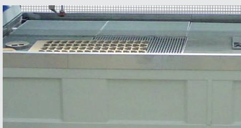
Milestone es un sistema de corte por chorro de agua avanzado, versátil, de altas prestaciones, tanto con agua pura como por hidroabrasión. Es capaz de adecuarse a las más diversas necesidades de producción en diferentes campos de aplicación, entregando un corte altamente preciso, incluso en 3D. La máquina consta de una estructura de puente con mesa fija, brazo móvil y guías, de movimiento ágil y de bajas tolerancias. Velocidades de corte hasta 40 mt/min.
