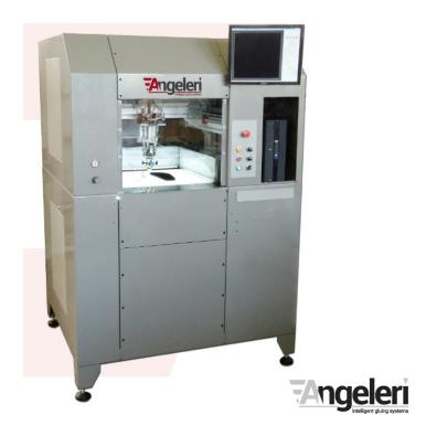
Sistema de encolado automático con 3 ejes Angeleri SP05/GSV5 para el encolado de suelas. Sistema que consiste en adquisición automática del perfil de la suela a través de un dispositivo de visión artificial y posterior encolado de la pieza. Trabaja de manera automática una vez designada la estrategia de encolado y definidos los parámetros de trabajo. Aplicación del adhesivo en forma de spray a lo largo de la trayectoria deseada para el encolado de la suela.
