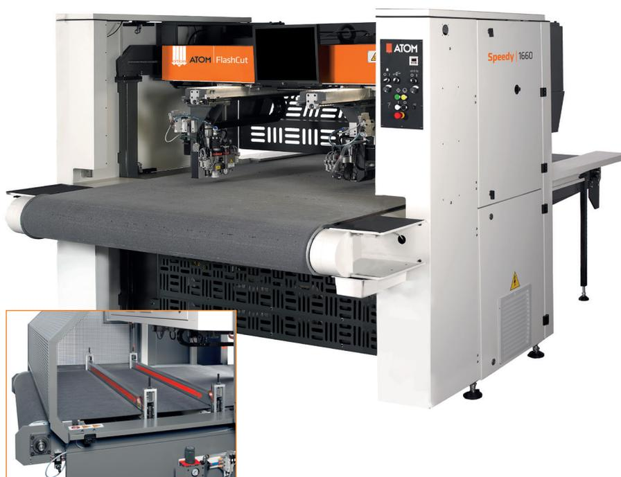
El sistema de alimentación de material con pinzas, unido a la contrastada potencia de corte y al doble cabezal, hacen que los **modelos BP sean perfectos para el corte de grandes producciones de materiales sintéticos, de una o varias capas.** Sistemas diseñados para obtener la máxima productividad y eficiencia de material, son ideales como solución de corte en los sectores del calzado y la marroquinería.
